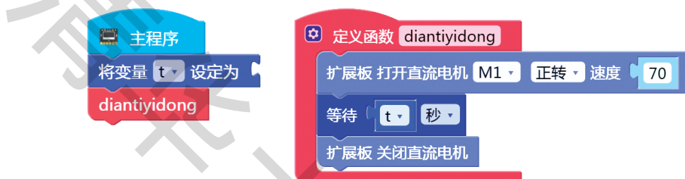
图 3.4.5 用来测试电梯移动一个楼层所需要的时间程序
