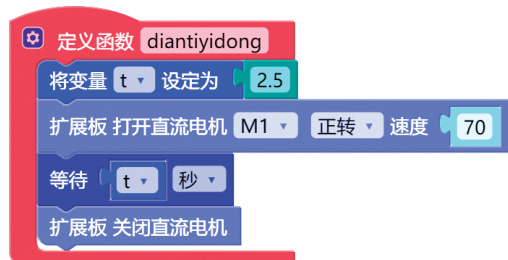
图 3.4.8 根据测试数据编写的电梯移动一层楼程序代码
