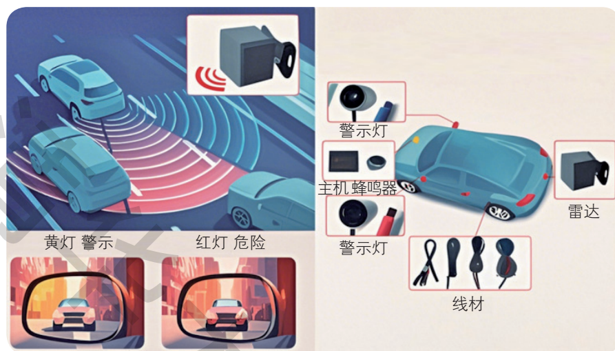
图 2.2.10 盲点监测系统示意图
