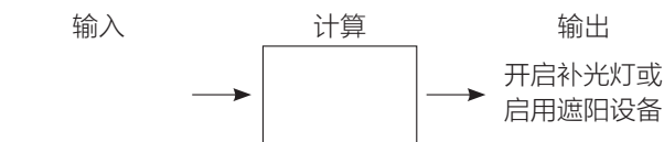
图 1.1.8 智能温室大棚内光照环境控制示意图
