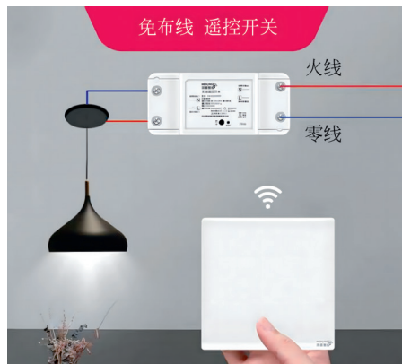
图 3.2.14 Wi-Fi 开关安装示意
