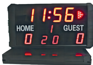
图 2.2.2 使用 LED 数码管的电子计分器
